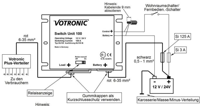
Sicherungen möglichst direkt an den Batterien anschließen (Leitungsschutz) mit z. B. Votronic Hochstromsicherungshalter und Kabelsicherungshalter.
