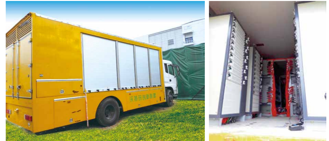
► Mobiles Energiespeicherfahrzeug der Firma OptimumNano Energy
